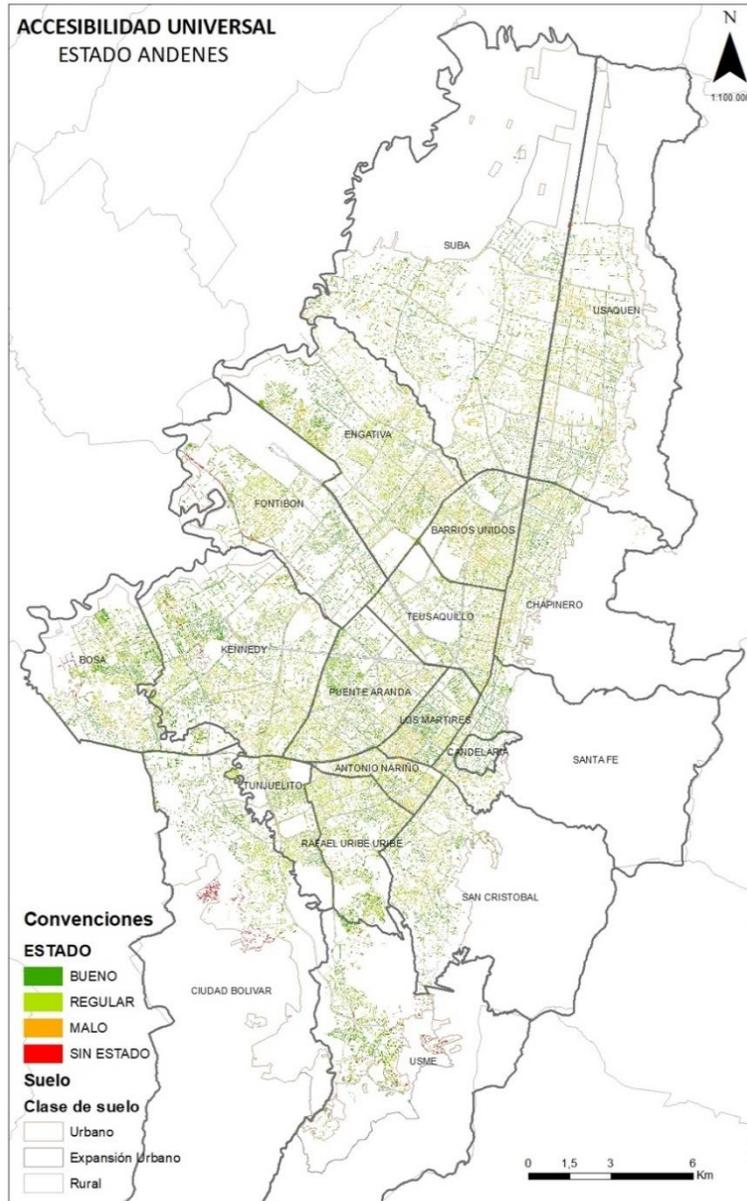
ILUSTRACIÓN 75 ESTADO ANDENES ACCESIBILIDAD UNIVERSAL. FUENTE: ELABORACIÓN PROPIA DTEP – SDP CON BASE EN INFORMACIÓN DADEP 2018
