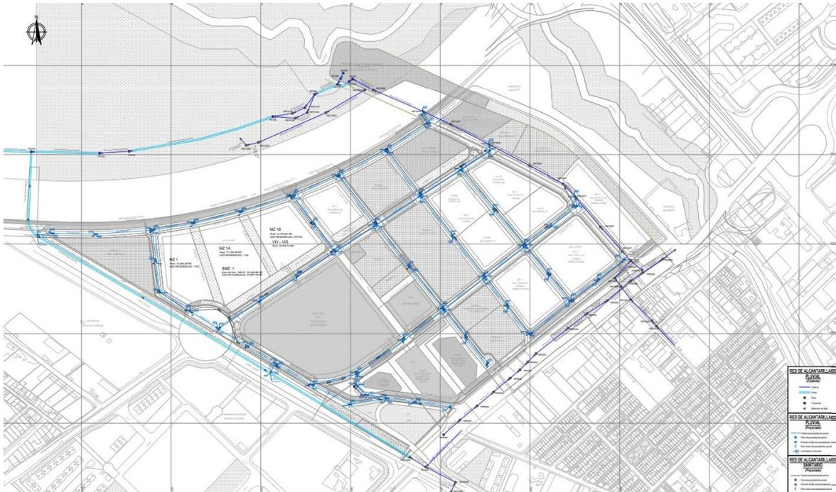
Ilustración 25. Plano de la red proyectada de alcantarillado pluvial PPD – Tramos, pozos, cotas
