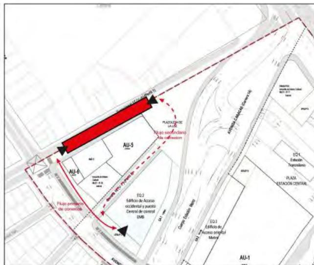
Ilustración 28 Esquema ubicación estación Regiotram
