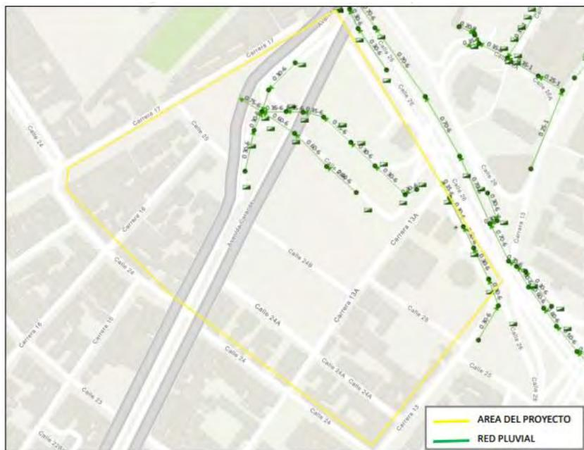
Ilustración 33 Red local de alcantarillado pluvial
