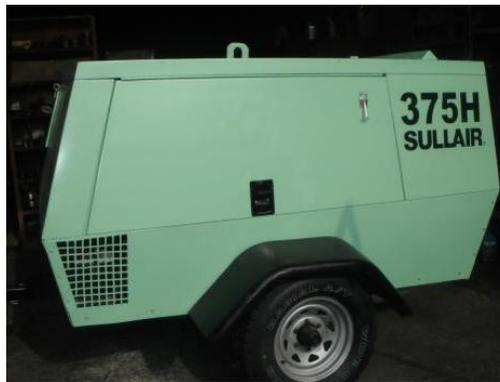
Figura 2: Compresor de Aire Referencia 375 H.
