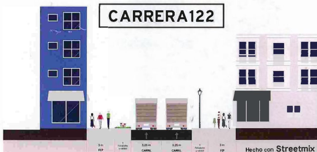
Imagen 39. Anchos mínimos carrera 122 Fuente: Elaboración SDM
