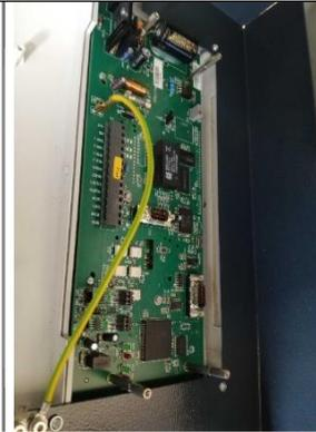
Estado de la Tarjeta AT: Revise que el led que esté alumbrado sea el verde, verifique que los cables de comunicación no estén rotos o sueltos (revise su conexión especialmente la tierra). -
