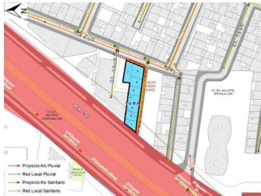
Imagen 2. Redes alcantarillado sanitario existentes. Fuente: SIGUE EAAB
