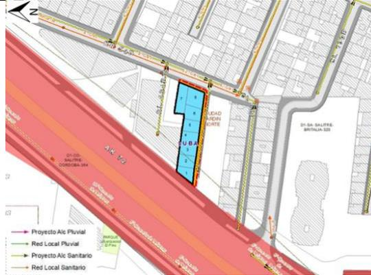
Imagen 3. Redes alcantarillado pluvial existentes. Fuente: SIGUE EAAB
