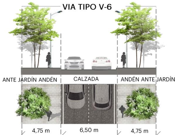
Ilustración: Perfil vía tipo v-6
