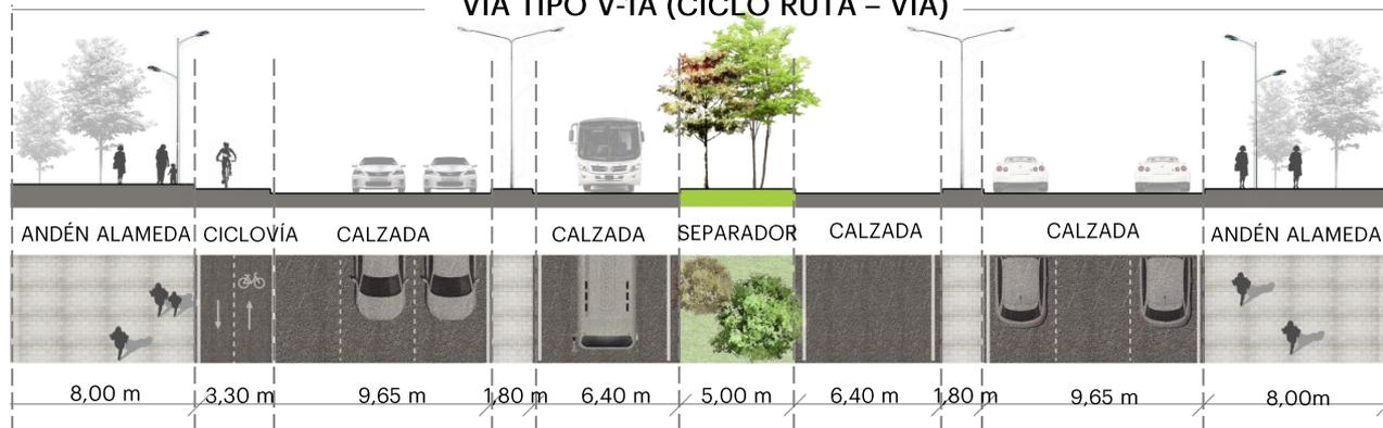
Ilustración: Perfil vía tipo v-1
