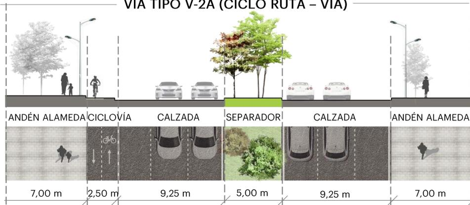
Ilustración: Perfil vía tipo v-2
