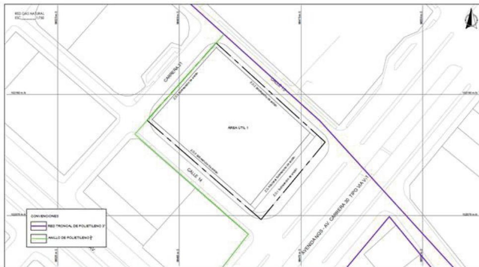
Figura 52. Trazados redes de Gas Natural, PPD-CLS.
