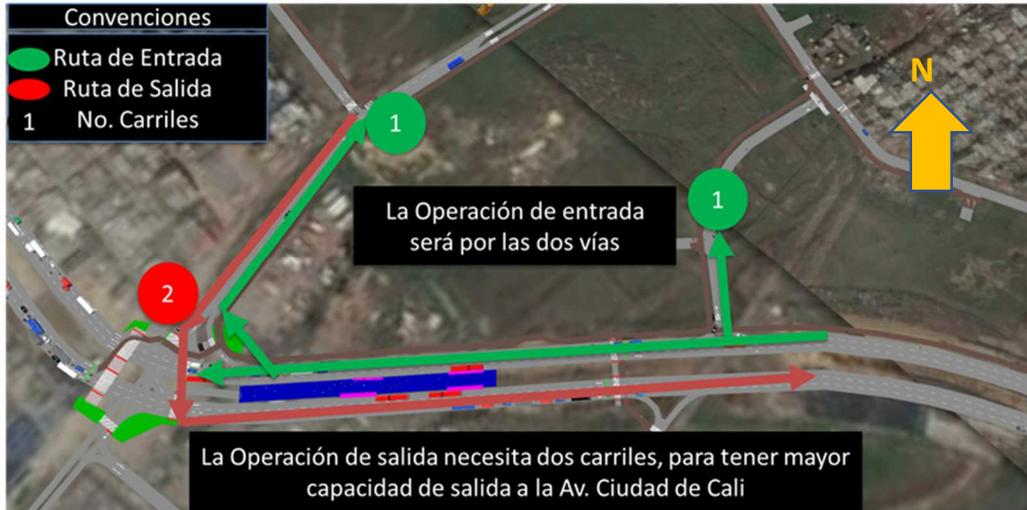
Ilustración 69. Esquema de Entrada y Salida al proyecto y necesidad de carriles.
