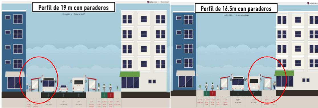
Ilustración 74. Sección transversal con paraderos
