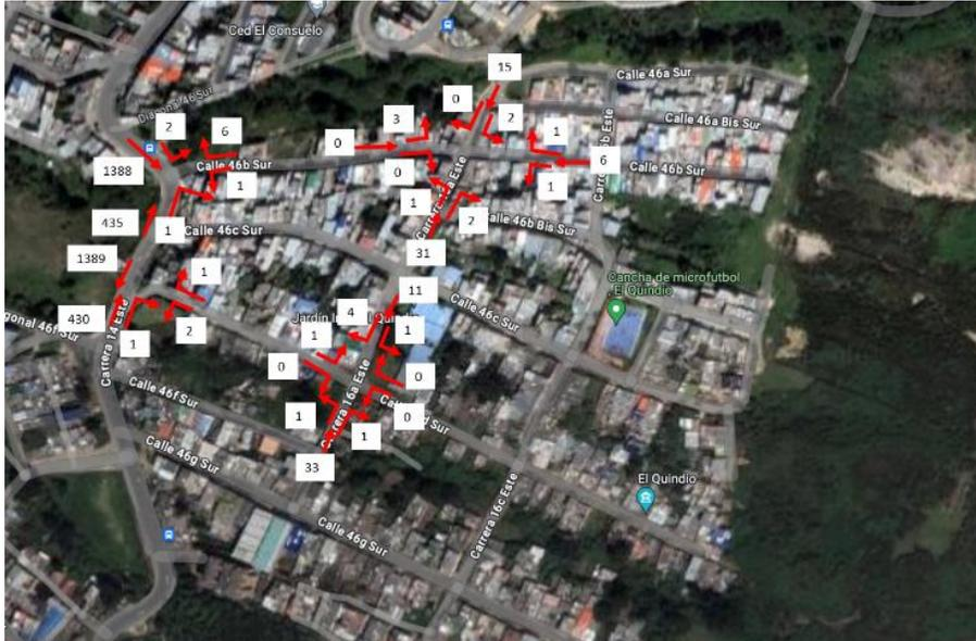
**Ilustración 164. Volúmenes vehiculares mixtos por movimiento HMD (Plano de Carga)**
