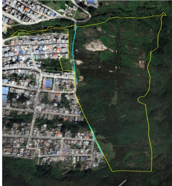
**Ilustración 66. Ubicación esquemática de la acequia que conduce el agua lluvia a las quebradas cercanas**
