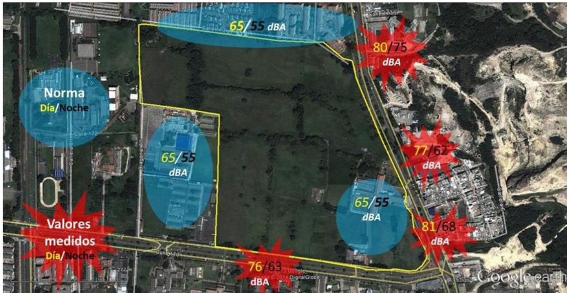
Ilustración 7. Mapa de ruido, comparando valores de norma con mediciones
