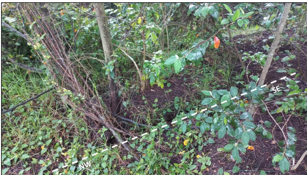
Fotografía 6. Área de inestabilidad con grieta de tensión
