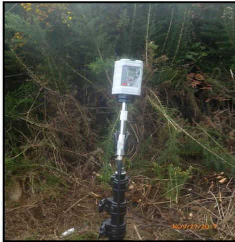
**Fotografía No. 13 Proceso de calibración acústica del sonómetro en campo**
