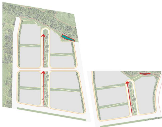
Figura 78 Filtración de aguas a través de zonas de Bio retención
