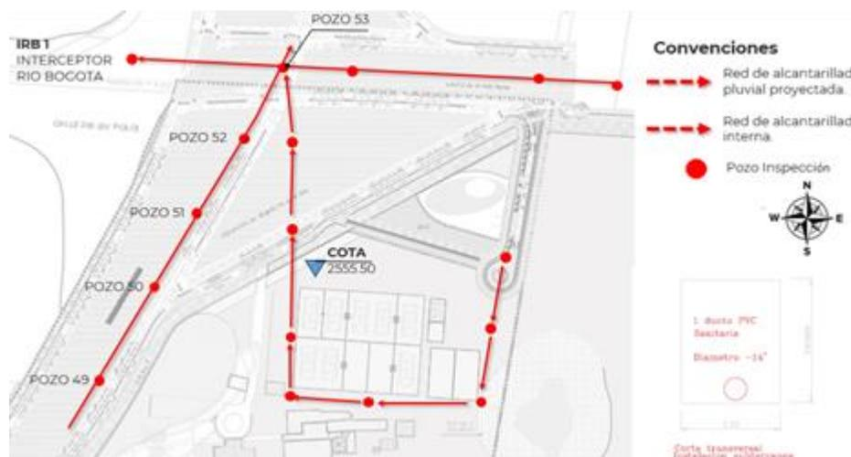
Figura 140 Red de Alcantarillado Pluvial
